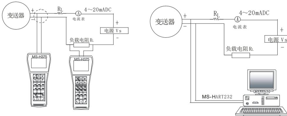
d) 本安防爆型变送器电气连接方法如下图所示：
