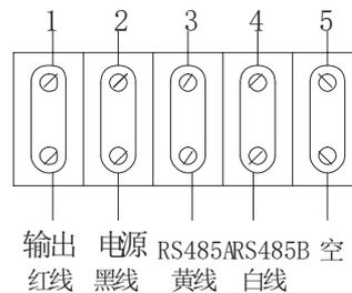
a) 二线制 4mA~20mADC 输出电气连接方法如下图所示。 接线盒内端子标识图
